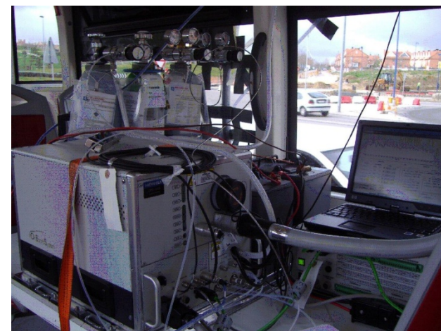
Detalle de la instalación del Equipo OBS 2200 en un Autobús
